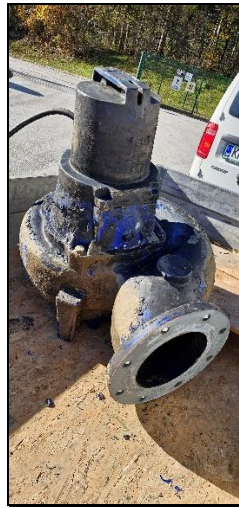
18.8.2025: Zamašen odtok centrifuge, čiščenje celotne odtočne cevi s kanal-jetom
