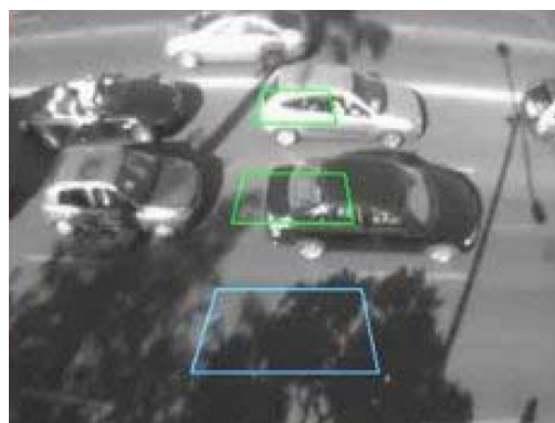
Slika 6–3: Sistem videodetekcije na parkiriščih
