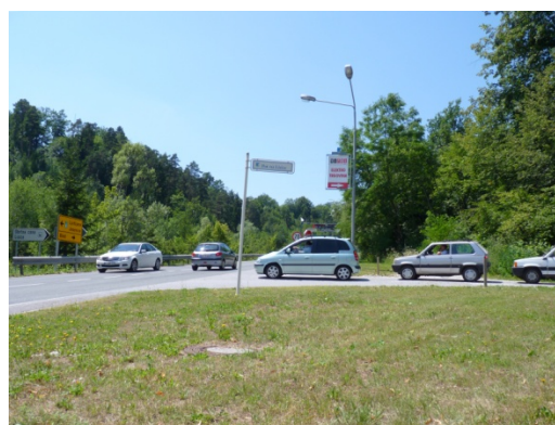
Slika 2-4: Križišče Ljubljanska c.–Pot na Lisce; prihaja do zamud v križišču, ker ni pasu za levo zavijanje
